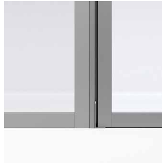
CERNIERA PIVOT cerniera nascosta nel telaio dell'anta intelaiata, invisibile quando la porta è chiusa. La cerniera pivot permette di scaricare il peso dell'anta a terra e non ha bisogno di regolazioni
